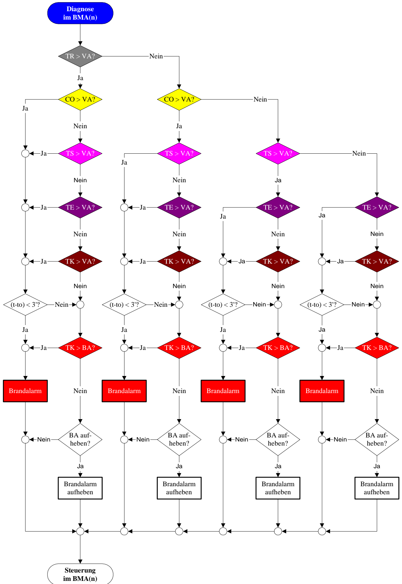
Schema 2: Vereinfachter Ablaufplan zur Diagnose des Brandfalls im Brandmeldeabschnitt n
