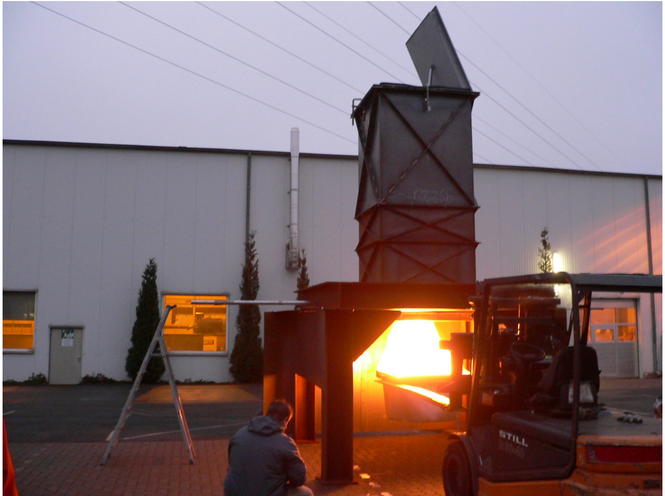
Bild 13: Vorprüfung der Flammensperre an einem Entrauchungsventilator mit Klappe
